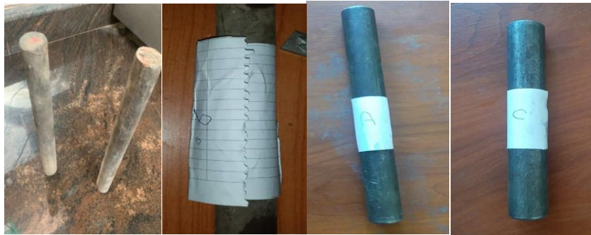
شكل (7) صور لعينات الحديد متوسط الكربون التي تم إختبارها
