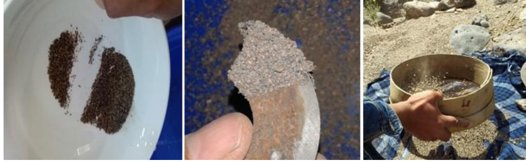
شكل (4) : عمليات فصل المعادن (الغلبة، المغناطيس، التعويم)
